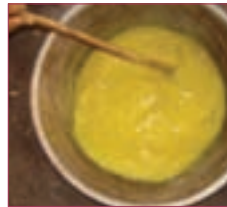
ទឹកព្រហ្មតក្រោយពេលលាយ ជាមួយម្សៅសាដួរ Prahout liquid after mixed with aluminum powder
